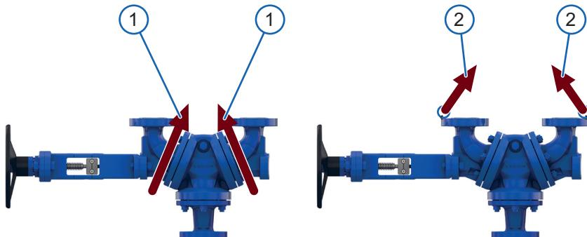
Possibilità di fissaggio per il trasporto
